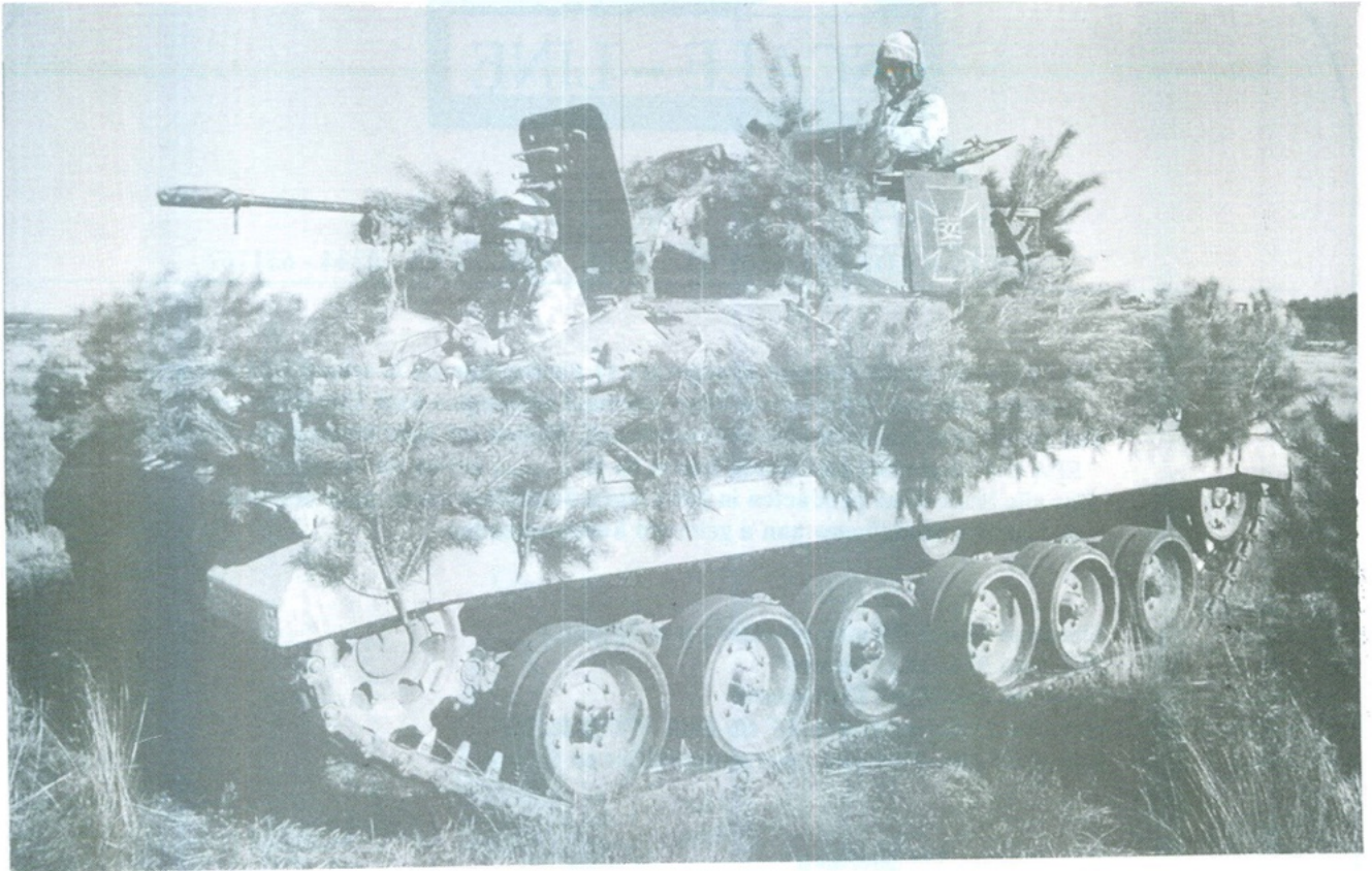
De Warrior; het werkpaard van de Britse gemechaniseerde infanterie. Een compagnie beschikt over veertien voertuigen. Twee van de commandovoering en twaalf voor het vervoer van de manschappen, verdeeld in drie pelotons. Het kruis is een tactisch teken dat tijdens een oefening wordt gebruikt.
